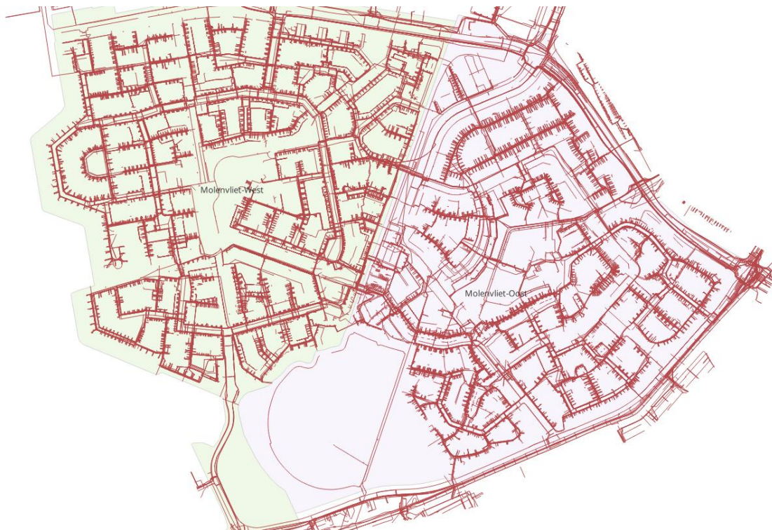
Figuur 26 – KLIC-kaart. Algemeen beeld van alle leidingen in de ondergrond. Het stratenpatroon is mooi zichtbaar, met per gebouwaansluiting de aftakkingen.
